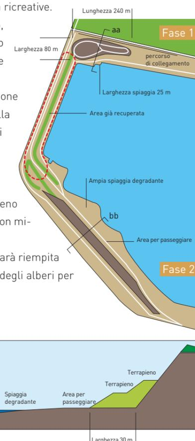
Schema per la costruzione del terrapieno con microfiller (Fase 1)
